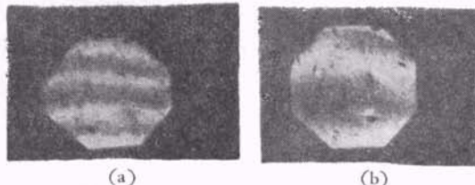
图 4 金刚石砧平行度调节时的干涉条纹 (a) 三个干涉条纹; (b) 一个干涉条纹
