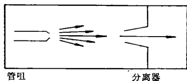
图3 超声分子束源示意图
