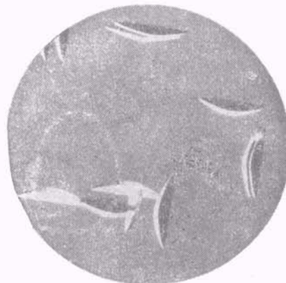
图 13 Si, (001), Wright 腐蚀剂, 热氧化层错, \times 1000
