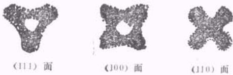
图8 由单晶表面溅射出的原子形成的 spot patterns,图中是用 100V 的离子照射 Ni
