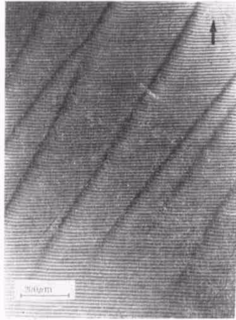
图 6 在地球上以 Czochralski 法生长的硅晶体中的生长条纹: I 型条纹和 II 型条纹, (箭头表示的方向为晶体生长方向)
