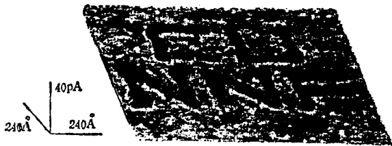
图 5 在 Au/Si 界面上用 BEEM 刻写的字符 (字符高度为 80nm)
