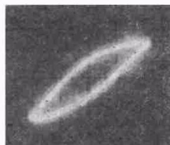
图 3 PLD 制得的 PZT 薄膜的电滞回线(x 轴: 62 kV/cm/div, y 轴: 4.8 \mu\text{C}/\text{cm}^2/\text{div} )
