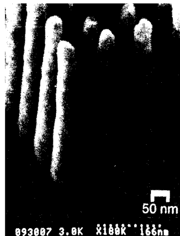
图4 量子存储器示意图及量子化 Ni 柱的扫描隧道电镜像
