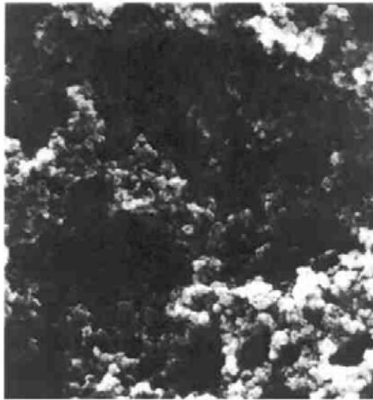
图3 从羰基铁超声制得的非晶铁纳米微粒扫描电镜照片(10—20nm)
