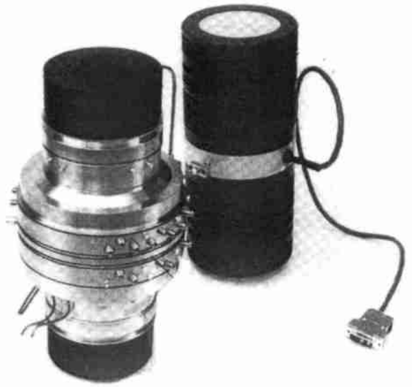
图8 欧洲SUCOM计划研制成的超导移动基站子系统斯特林制冷机,左侧圆柱体是制冷机主体,内装超导微波器件和放大器,右侧圆柱体为压缩机(引自文献[5])
