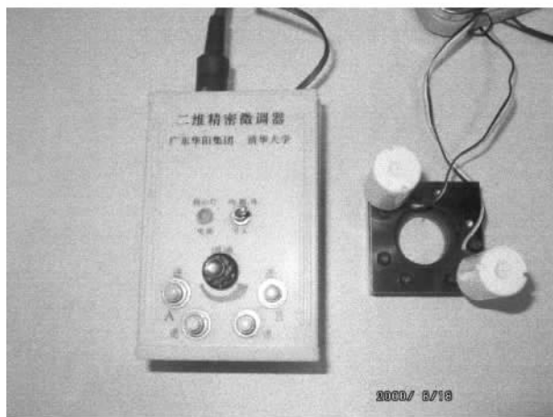
图4 清华大学的压电超声马达控制的二维微动平台
