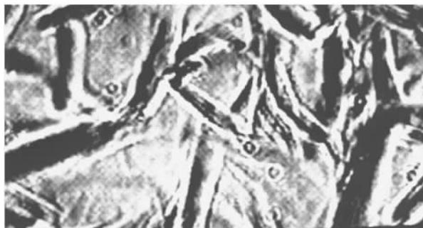
图 4 声波处理前溶蜡油晶体结构 (放大 400 倍)
