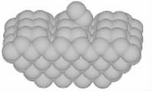
图3 在裸露的金刚石(100)表面插入 C_2 基团可导致一个金刚石晶体形核位置的产生 [6]
