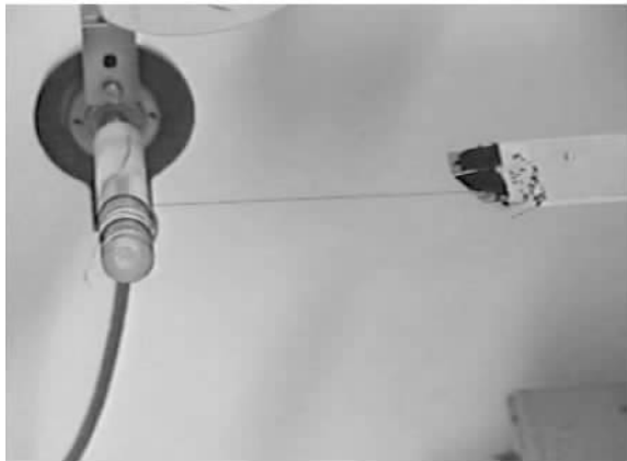
图4 超声马达驱动下连续地从碳纳米管阵列中抽出线来
