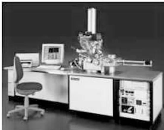
图 17 Cameca IV型飞行时间二次离子质谱仪
