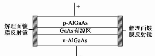
图 1 双异质结激光器的示意图
