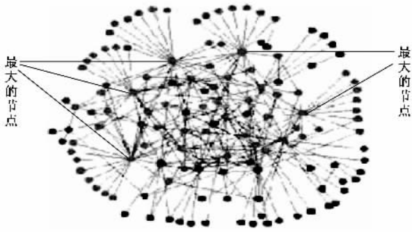
图2 无标度网络的拓扑结构示意图(本图展示了有130个节点的BA网络,其节点度服从幂指数为-3的幂律分布.图中标注的5个节点是网络中度最大的5个节点)
