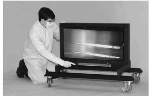
图 3 LLNL 制作出的世界上最大的多层介质膜光栅
