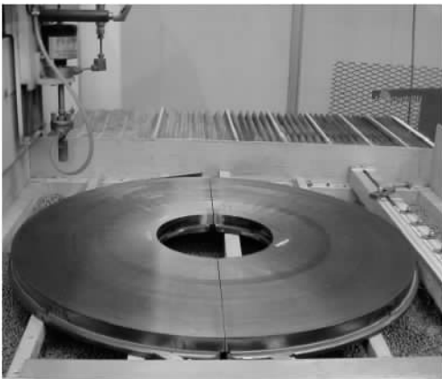
图6 经过水切割的磁合金环
