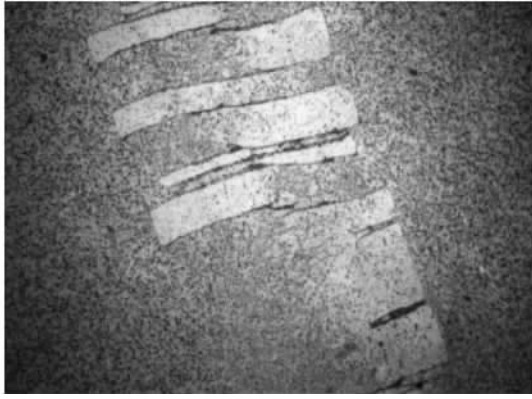
图4 铁薄膜有序结构中畴块的形貌(照片面积为 145 \times 105 \mu\text{m}^2 , \Delta t = 15 \text{ h} , f = 0.6 \text{ nm/s} , d = 20 \text{ nm} )
