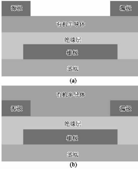
图1 两种典型 OFET 结构示意图 (a)顶接触 (b)底接触
