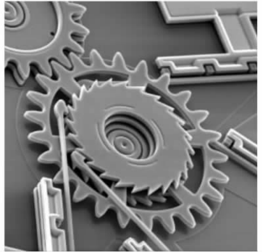
图2 美国SANDIA国家实验室利用多层硅平面工艺(SUMMIT)制作的微机械齿轮
