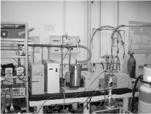
图 3 中国科学院物理研究所极端条件实验室光反射谱测量系统。(光谱仪为 Bruker 公司 IFS 66v/s 型)
