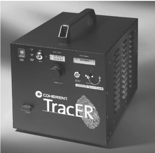
Coherent(相干)公司推出独特而功能强大的新型 TracER™激光器,用于犯罪现场的痕量物证,包括隐约残留指纹的采集。TracER 使用 5W 的绿光激光器。TracER 的高输出功率大大提高了在犯罪现场进行无损搜索的效率,可以仅依据特征荧光采集指纹或其他痕量物证。同时,532nm 波长非常适合于使用烟熏样品和荧光探针如茚三酮(ninhydrin)。
