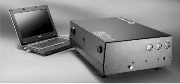
Coherent(相干)公司(www.coherent.com.cn)推出新的非共线光参量放大器(NOPA)OPerA™™ – TOPAS – White,可以从紫外到近红外连续调谐。即使采用脉冲宽度超过 100fs 的钛宝石超快放大器泵浦,非共线设计使 OPerA – TOPAS – White 仍然能够输出 25fs 以下的超短激光脉冲。相比之下,采用传统 OPA 获得超短脉冲需要更复杂而且更昂贵的超短卖出放大器系统泵浦。
