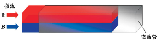
图1 微流管中流动着的两种液体
