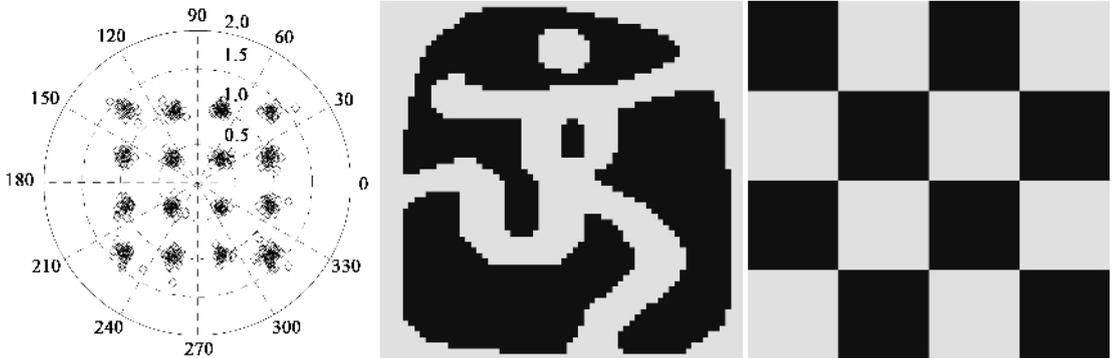
图5 接收解调后的 16QAM 星座图和解调后无误码的图像
