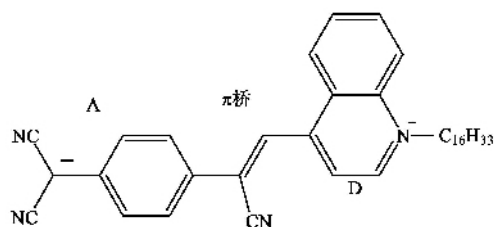
图4 D- \pi -A型分子C 16 H 33 Q-3CNQ的结构 [52]
