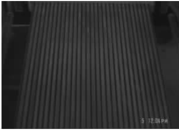
图3 四极结构的DBD等离子体(30cm×20cm)
