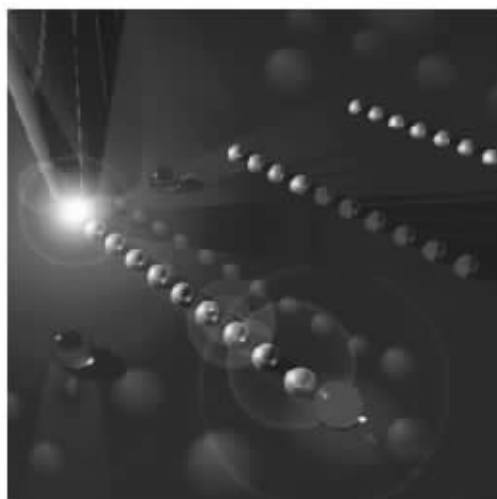
图 3 金属纳米颗粒阵列形成的 SPPs 波导结构
