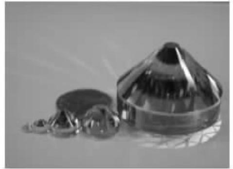
图 2 各种碳化硅单晶压砧.为了比较,在最左边放置了金刚石压腔实验中最常用的 1/3 克拉的金刚石压砧,后面放置了一枚硬币
