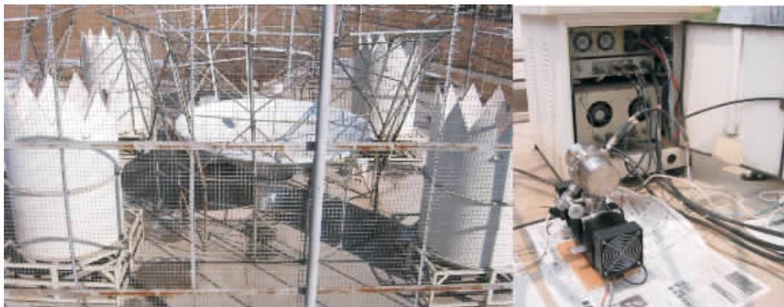
图5 高温超导子系统与风温廓线雷达联机试验现场(左图为雷达天线,右图为雷达接收机和高温超导子系统)
