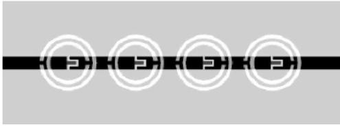
图5 基于CSRRs的微带线型特异材料的结构示意图
