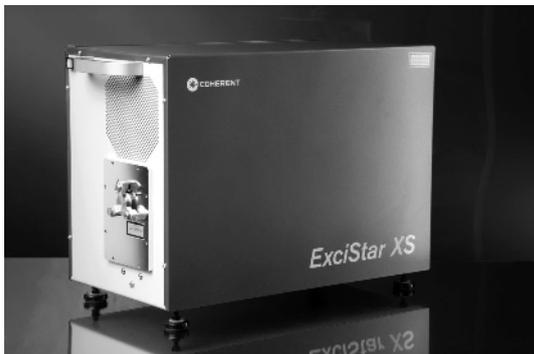
Coherent(相干)公司生产的最新推出一款结构紧凑、性能卓越并具有超长使用寿命的经济型 Excistar XS 准分子激光器. 特别是空气冷却的 Excistar XS 激光器, 外形尺寸仅为 649 × 300 × 400 mm, 却能在重复频率高达 500Hz, 波长为 193nm 时, 输出脉冲能量高达 10mJ, 能量稳定性小于 2% (1 $\sigma$ ). Almeta XS 全金属结构, corona 预电离, 全固体脉冲发生器以及静电尘去除技术的使用, 确保了激光腔的寿命高达 500 百万个脉冲数, 腔镜的寿命高达 100 百万个脉冲数.
