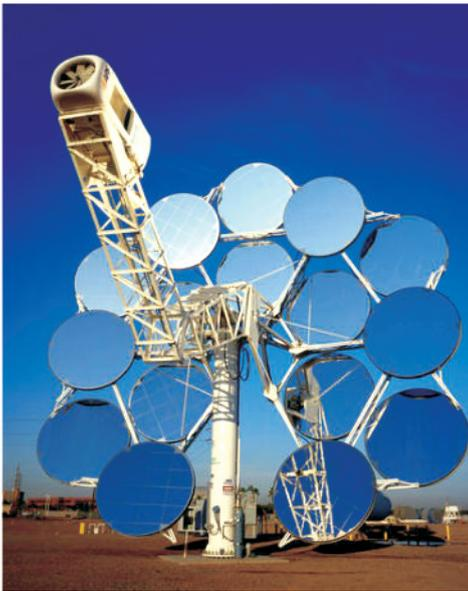
图4 多碟太阳能热发电系统
