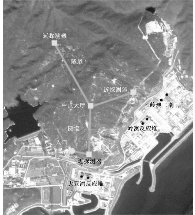
图7 大亚湾中微子实验的总体方案图,包括2个近探测器实验厅和1个远探测器实验厅,用水平隧道相连
