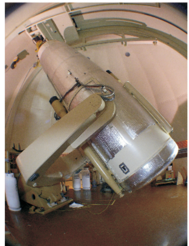
图 6 帕洛马山天文台的施密特望远镜,主镜口径 1.86m,改正透镜口径 1.22m
