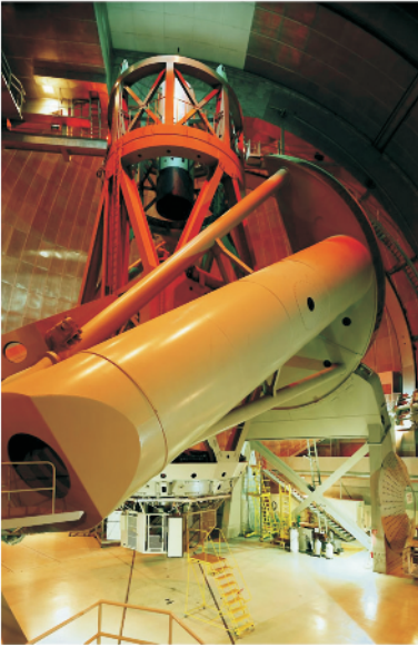
图 5 1948 年落成的口径为 5.08m 的海尔望远镜
