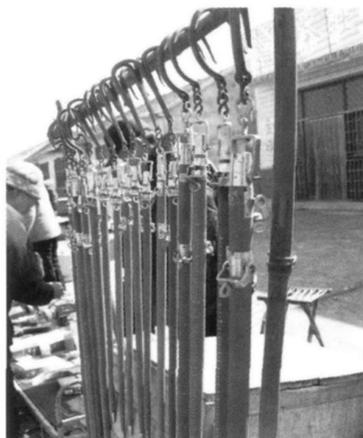
图3 杆秤. 杆秤连同秤砣和待称物品一起被从支点处吊起,滑动秤砣的位置使秤杆 (朝尾端渐细)处于水平状态,则此时秤砣的位置就是待称物品质量的读数.有时,一杆称配两个秤砣,秤杆上有类似计算尺似的两套刻度.杆秤是量具,更是艺术品
