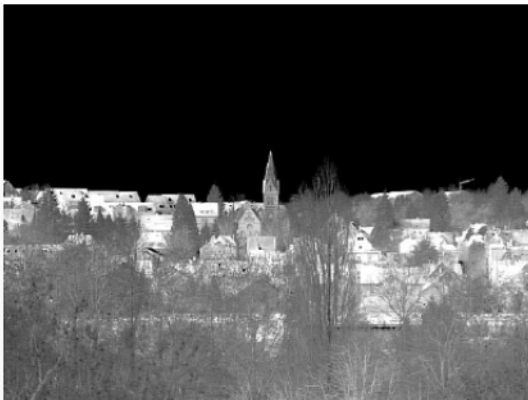
图4 640 × 486 像素的 PV-QWIP 焦平面阵列对室外场景的热成像图, 其热分辨率达 9.6 mK [15]
