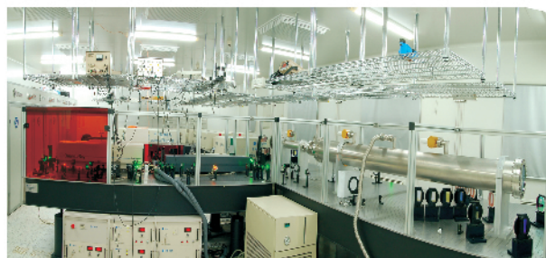
图 3 物理所自建的 350TW 超强飞秒激光装置
