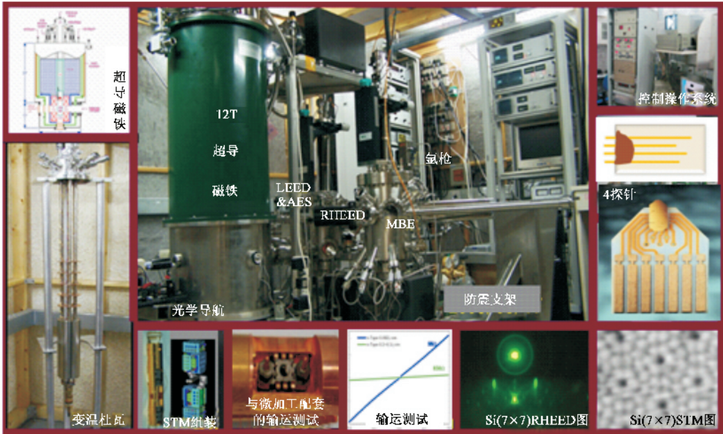
图 7 超高真空低温强磁场双探针 STM 和 MBE 联合系统(图中 LEED 为低能电子衍射 ,AES 为俄歇谱仪 ,RHEED 为反射式高能电子衍射仪 ,MBE 为分子束外延 ,STM 为扫描隧道显微镜)
