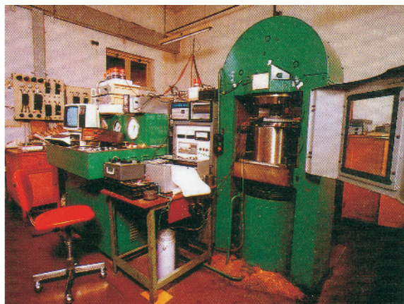
3150 吨预应力绕带式压机,用于合成金刚石
