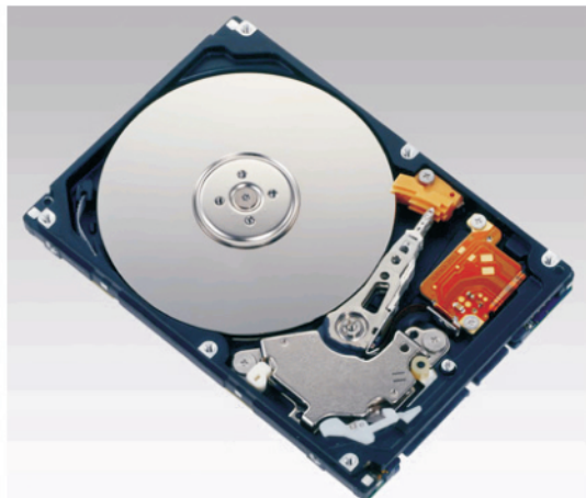
图1 硬盘的内部结构
