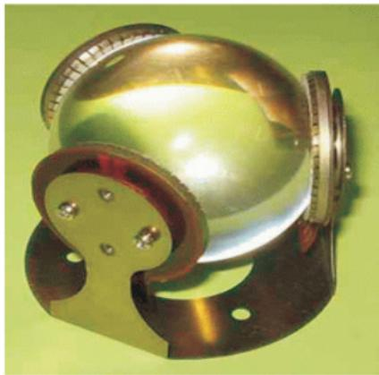
图 2 实用化的球形多自由度电机
