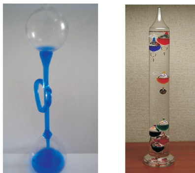
图2 原始的 thermoscopes. 左图中利用的是气压随温度的变化,观察的是液体的升降;右图中利用的是液体密度随温度的变化,观察的是固体悬浮物的升降
