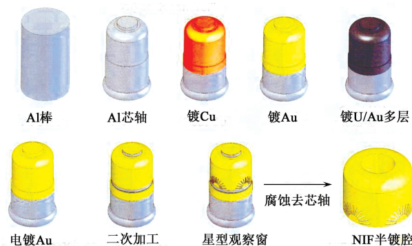
图 4 “鸡尾酒”柱腔制备工艺流程
