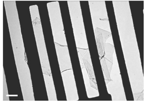
图 1 自由悬空的 Graphene 的透射电子显微像(标尺 500 nm. 图片引自文献 [20])
