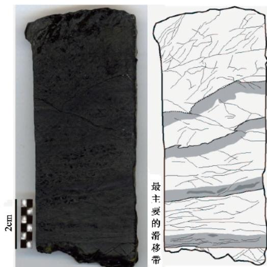
图8 主要滑移带抛光后的构造及其描绘图像。单独的一层错动区域厚度约2—3cm,底部5mm处颗粒细小,位于主要错动区域的最下层处,有一2cm厚的区域,并无明显的搅动,显示可能为最近发生错动的位移带,因此推断为最主要滑移带(major slip zone, MSZ)
