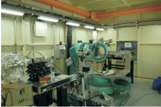
图9 BL14B1 实验站主要设备——6 圆衍射仪
