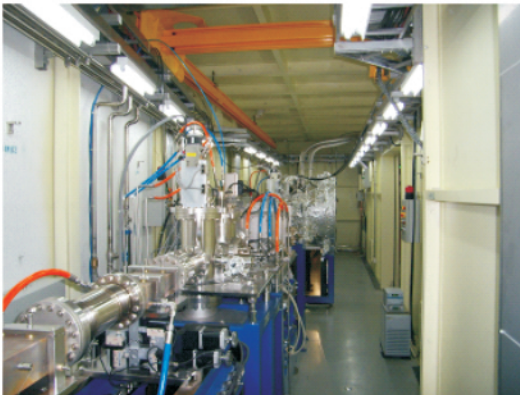
图9 BL14B1 实验站主要设备——6 圆衍射仪
