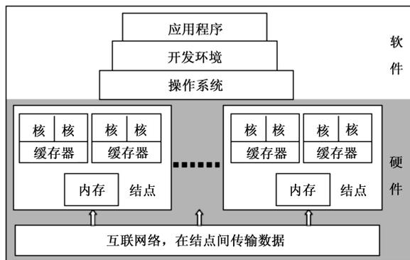
图 3 高性能计算机系统的示意图
