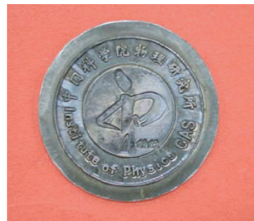
图8 金属塑料在开水中这种简单条件下压印的中国科学院物理研究所的所徽图案,直径为20mm
