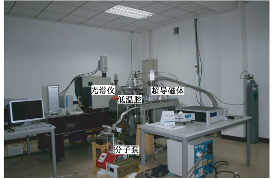
图 1 低温强磁场拉曼散射系统.其中超导磁体采用脉冲管制冷系统,光谱仪采用 T64000 三级光栅光谱仪,探测器是背照射 CCD,激光采用 532nm 绿光和 632.8nm 红光,光路采用垂直背散射共焦显微形式或膜背散射形式
